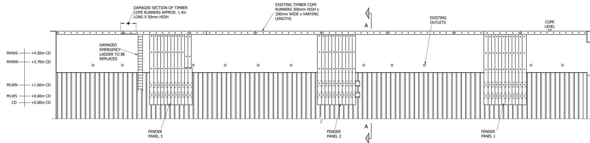
**ELEVATION ON DD3 LEAD IN WALL**
